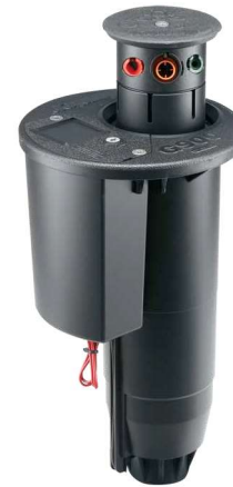
G995E Altura de emergencia: 8 cm Altura tota: 34 cm Diámetro de la tapa: 19 cm Rosca: 1/2" hembra ACME
